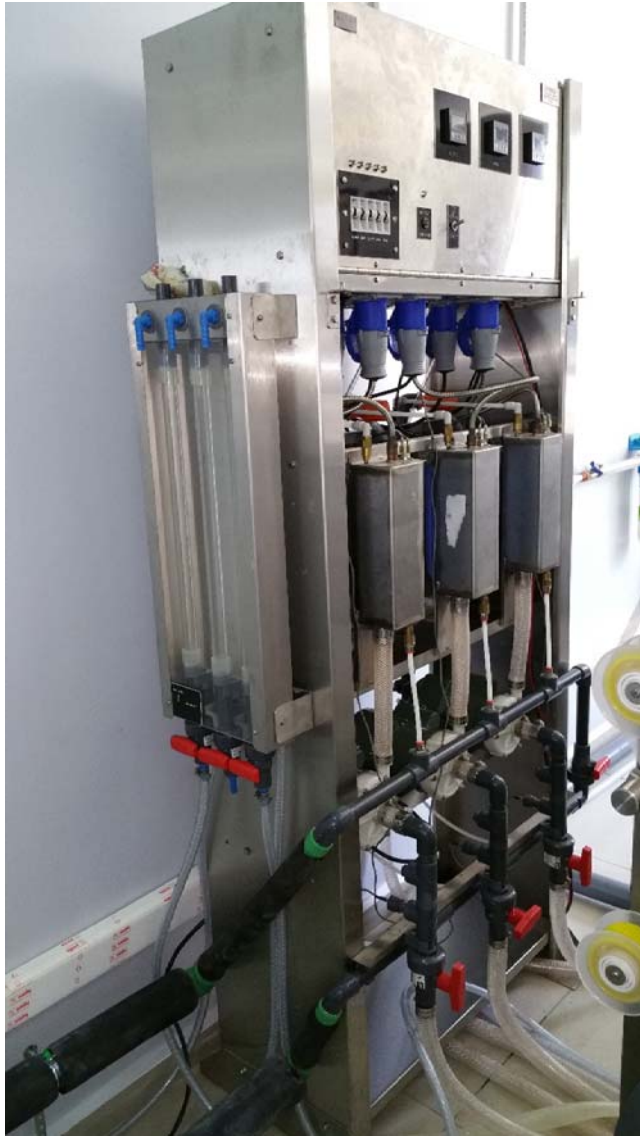
Groupe de circulation des bains avec contrôle des températures
